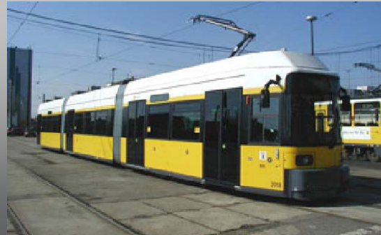
45 Niederflurgelenktriebwagen (GT6N ZR)
