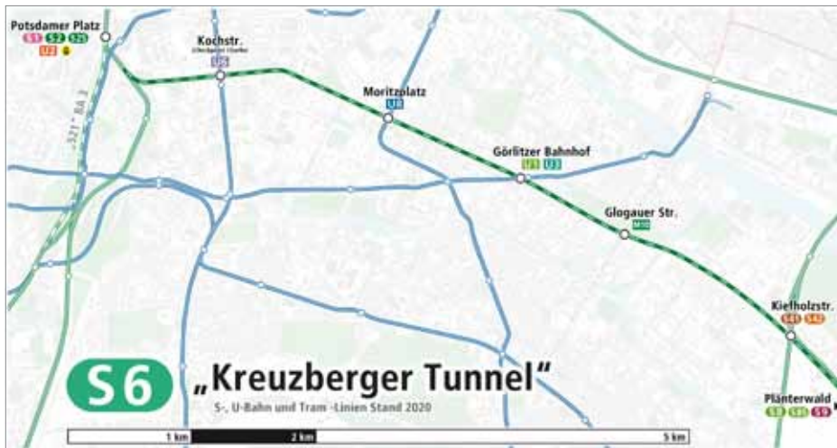
Der visionäre Kreuzberger Tunnel bildet das Kernstück der neuen S6 und verknüpft die S-Bahn im dichten Takt mit den kreuzenden Linien U1, U3, U6 und U8. Die Einbindung soll in den bestehenden Nordsüd-S-Bahn-Tunnel zwischen Anhalter Bahnhof und Potsdamer Platz in der Stresemannstraße erfolgen.
