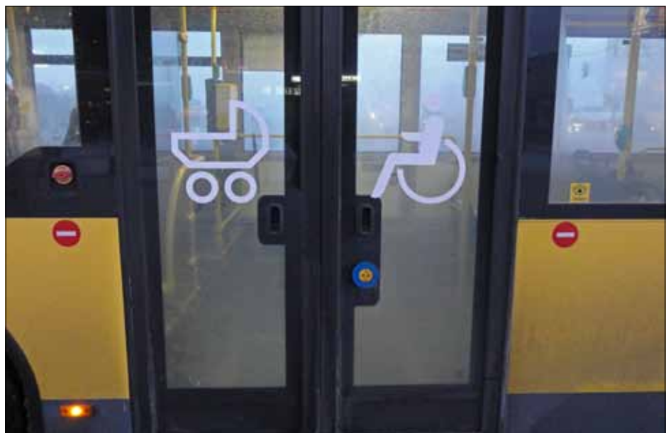
... übrigens die gleiche, wie beim Druck auf den Kinderwagen- und Rollstuhlknopf an der zweiten Tür. Falls der Fahrer diese Lampe beim Kontrollieren der Fahrscheine überhaupt bemerkt, wird es schwierig, herauszufinden, welcher Fahrgast welchen Service möchte. Will ein Rollstuhlfahrer an der zweiten Tür ein- oder aussteigen? Oder ein Kunde mit Kinderwagen? Benötigt jemand das Absenken für sich oder ein Gepäckstück? Die Reaktion des Fahrpersonals: Lampe solange ignorieren, bis einer meckert. Die logische Konsequenz für den Test der Praxistauglichkeit des Bedarfskneelings kann daher nur lauten: Test gescheitert, Zwangskneeling wiederherstellen! Fotos: Holger Mertens
