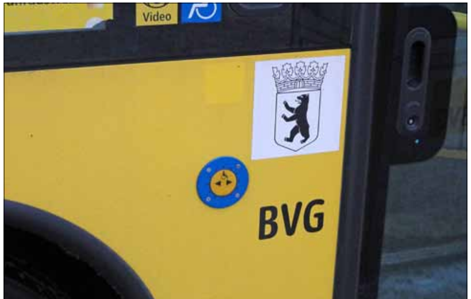
Soll sich der Bus beim Einstieg absenken, muss diese extra neu eingebaute Taste rechts neben der ersten Tür gedrückt werden. Der Fahrer soll dann eigentlich den Bus absenken. Jedoch leuchtet beim Fahrer lediglich eine Lampe auf dem Armaturenbrett auf ...
