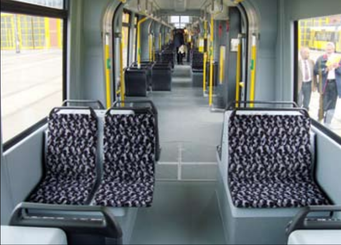
Blick in den Innenraum des Einrichtungsfahrzeugs. Deutlich die konsequente 1 plus 1,5-Bestuhlung und die großen Mehrzweckbereiche an den Türen. Foto: Florian Müller
