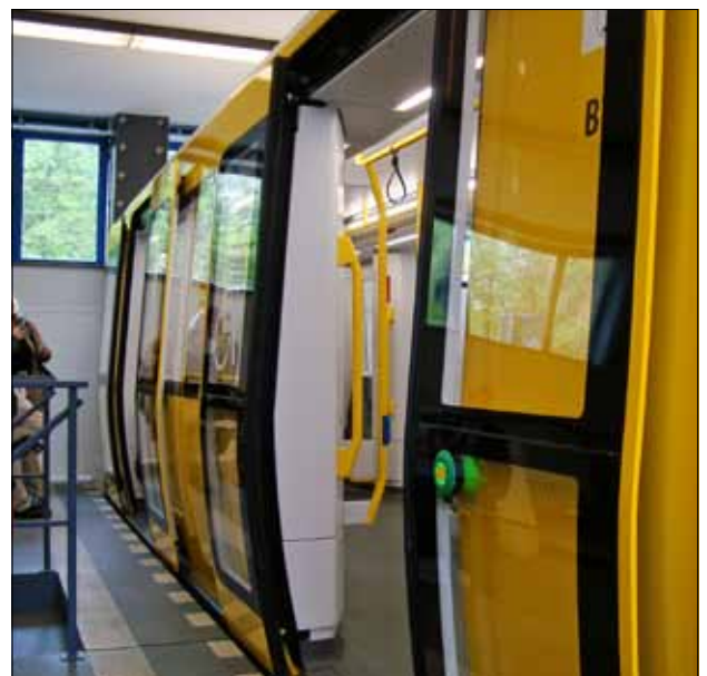
Von der Seite kann man die „Bombierung“, also das leichte Auswölben der Seitenwände für mehr Platz im Inneren, gut erkennen.
