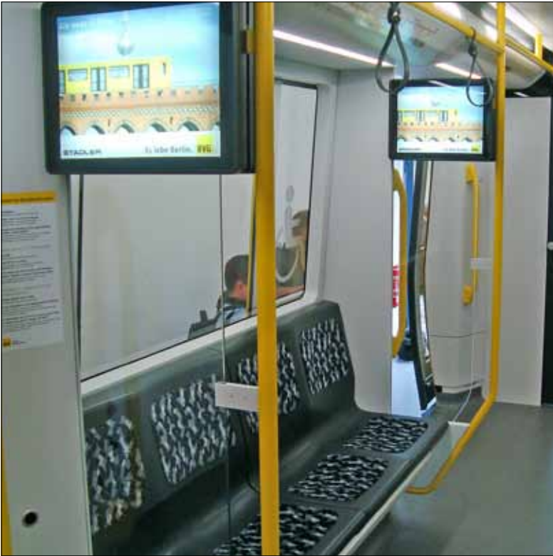
Die neuen IK-Fahrzeuge will die BVG mit Hartschalensitzen ausstatten. Der insgesamt positive Eindruck des Modells wird durch diese harten Sitze der „4. Klasse“ deutlich geschmälert. Das Mehrzweckabteil (rechts) ist im Gegensatz zum HK-Zug von den Wagenübergängen zu den Wagenspitzen gewandert. Fotos: Florian Müller
