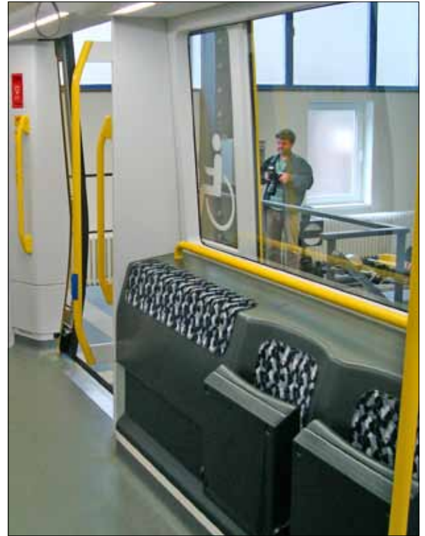
Die neuen IK-Fahrzeuge will die BVG mit Hartschalensitzen ausstatten. Der insgesamt positive Eindruck des Modells wird durch diese harten Sitze der „4. Klasse“ deutlich geschmälert. Das Mehrzweckabteil (rechts) ist im Gegensatz zum HK-Zug von den Wagenübergängen zu den Wagenspitzen gewandert. Fotos: Florian Müller
