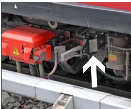
Mechanische Fahrsperrung der Berliner S-Bahn. Viele Fahrsperrschalter froren ein, weil die Winterpflege durch Personalmangel unzureichend war. Foto: Marc Heller
