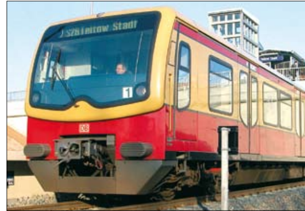
Zug der Baureihe 481 in Teltow Stadt. Ausgerechnet die modernsten Züge der Berliner S-Bahn dürfen aus sicherheitstechnischen Gründen maximal 80 statt 100 km/h fahren, bis die Bremstechnik nachgebessert wurde. Damit sind häufigere Verspätungen auf einigen Linien vorprogrammiert – vor allem auf eingleisigen Abschnitten.
